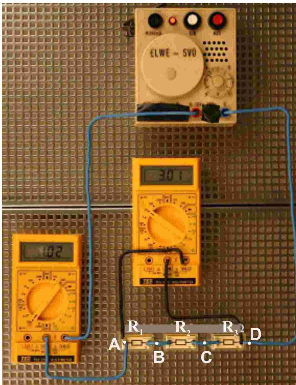
Con los datos que se dan en la foto, con una fuente variable de corriente, un amperímetro (en mA), un voltímetro (en V) y teniendo en cuenta que  $R_1$ , es el doble que  $R_2$  y ésta a su vez que  $R_3$ , determinar:
