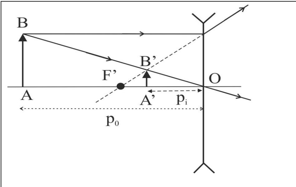
La imagen se forma a través del corte entre las prolongaciones de los rayos paralelos al eje óptico  $AA'$  que pasan por el  $F'$ , y los que pasan por  $O$ , que no se desvían.
