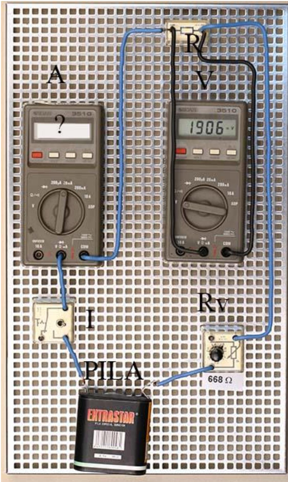
En el circuito de la figura, con una pila que suministra 4,5V y con los datos que se toman visualmente, una vez cerrado el interruptor I, determinar:
