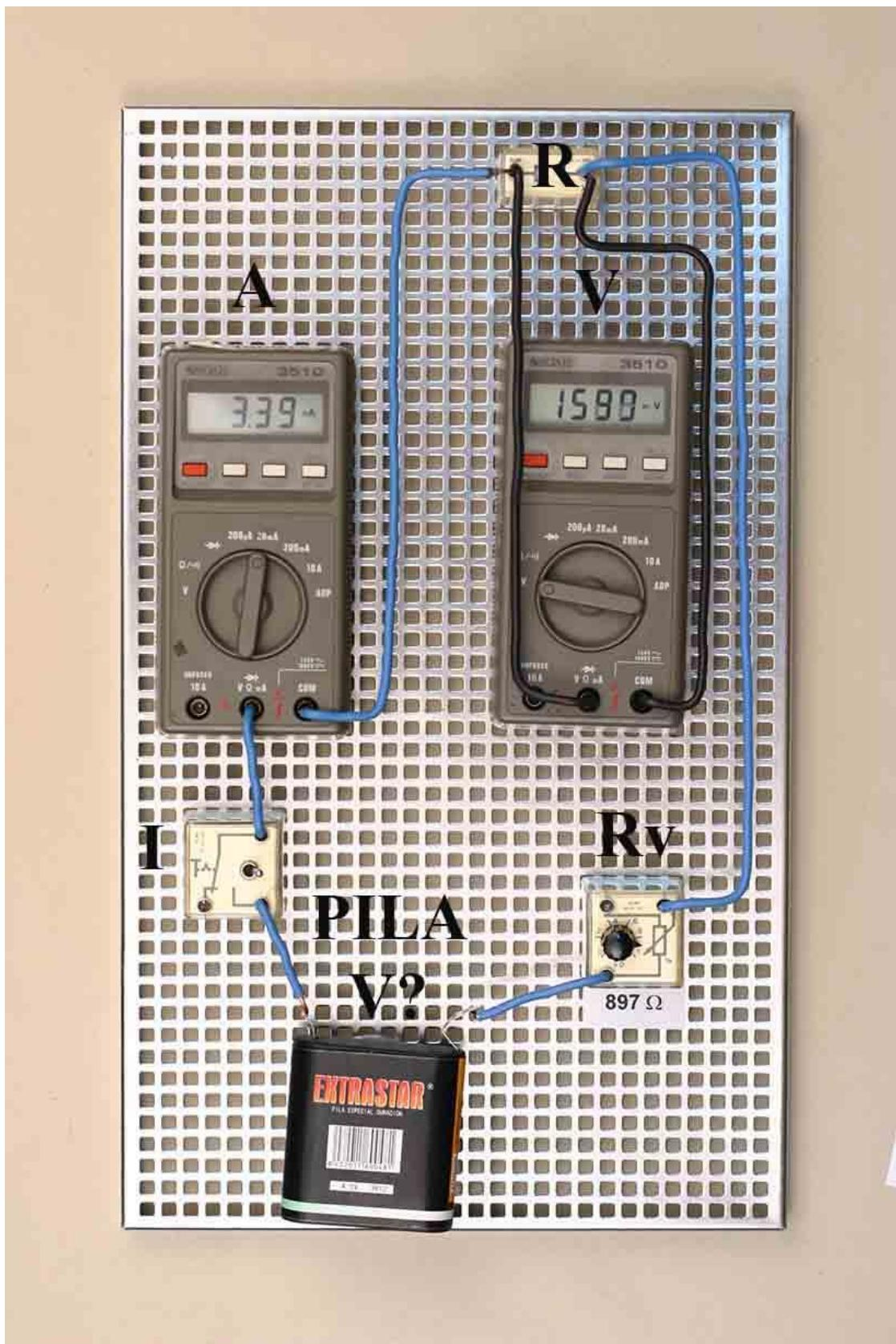
En el circuito de la figura, con una pila que no conoces el voltaje que suministra y con los datos que se toman visualmente, una vez cerrado el interruptor I, determinar:
