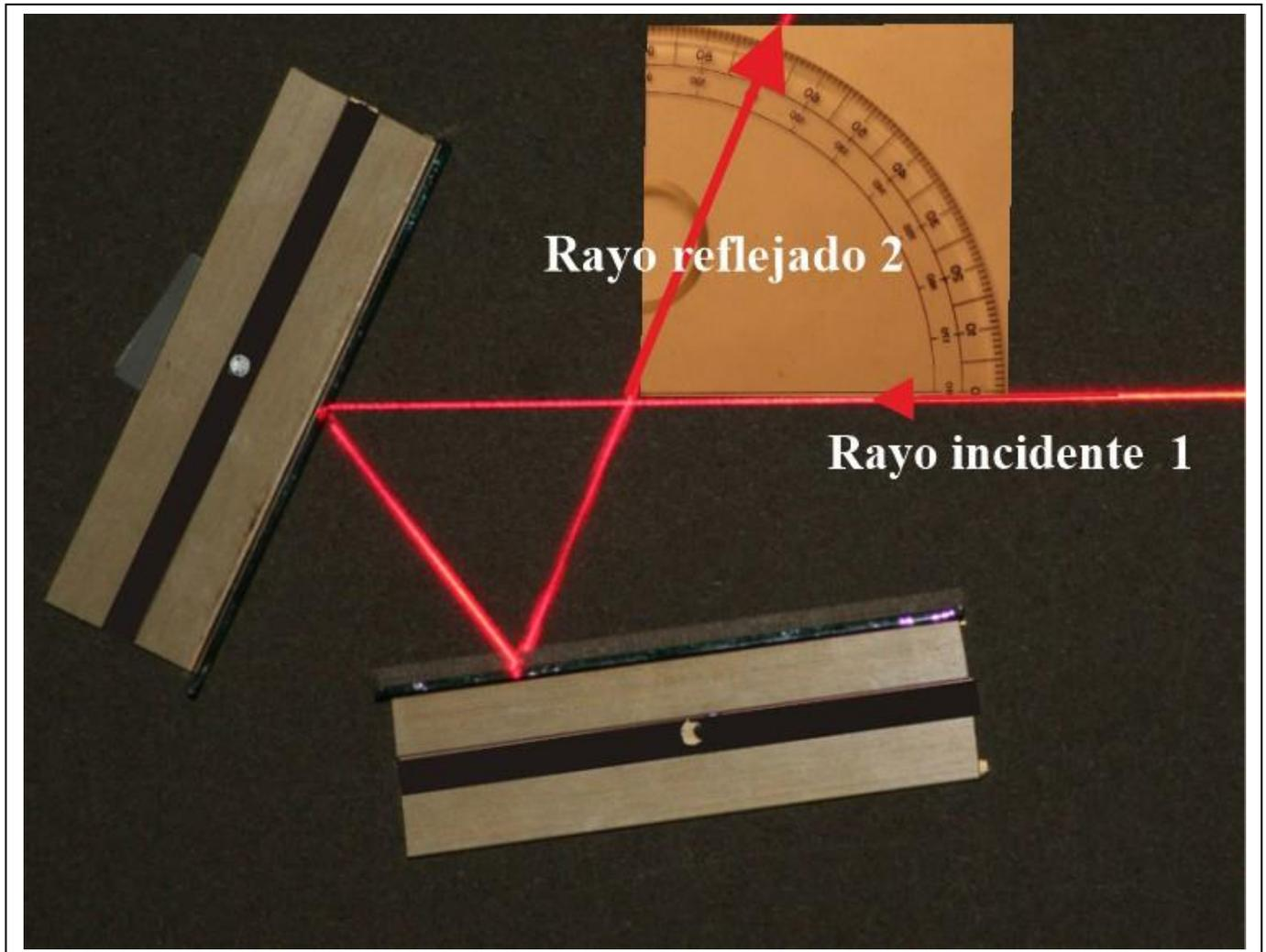
Un rayo láser ( rayo incidente 1) penetra en un espacio donde dos espejos de 20 cm de longitud, forman un ángulo determinado reflejándose y saliendo de ese espacio (rayo reflejado 2). Determinar, con los datos de la foto:
