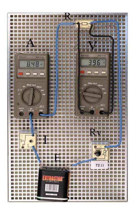
En el circuito de la figura y con los datos que se dan (se toman visualmente), determinar la potencia total suministrada por la pila.
