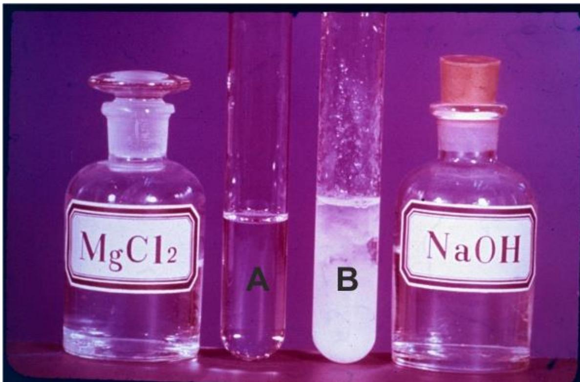
En A, se disponen 25 mL de disolución de cloruro de magnesio. Se le agregan 5mL de disolución de hidróxido sódico, tomando el aspecto que se aprecia en B. Se pregunta:
