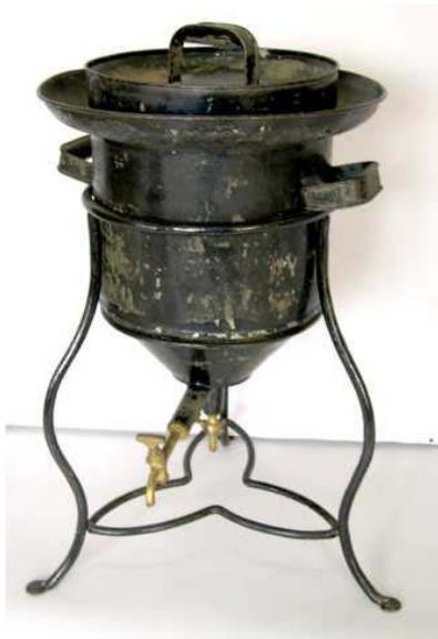
Fig.1. Calorímetro de hielo
