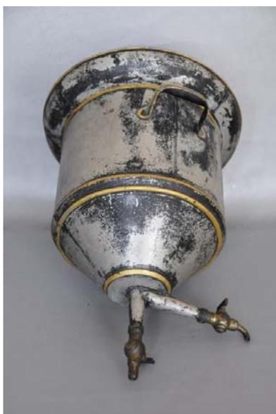
Fig.2. Calorímetro de hielo
