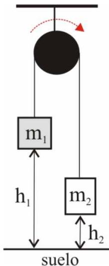
2.3.11. En la figura adjunta, la polea es de masa despreciable y se supone que no hay ningún tipo de rozamiento. El principio de conservación de la energía lo podemos escribir (suponiendo que tal como está la figura, inicialmente la velocidad de las masas es cero y que  $m_2 > m_1$ ):
