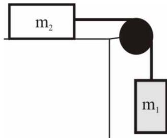
2.3.12. En el sistema de la figura se supone que la polea es de masa despreciable y no existen rozamientos. Suponiendo que el bloque  $m_1$  se encuentra inicialmente a una altura  $h$  sobre el suelo y en reposo. El principio de conservación de la energía lo podemos escribir con alguna de las ecuaciones siguientes:
