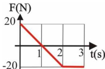
2.3.2. Sobre un móvil de masa 10 kg que está en reposo en el tiempo  $t=0$ , actúa una fuerza variable tal como se indica en el diagrama de la figura. Si el cuerpo se mueve en una trayectoria rectilínea, la energía cinética del móvil en julios, a los 3 segundos es:
