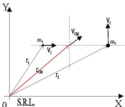
3.4.10. Dos partículas de masas  $m_1= 1\text{kg}$  y  $m_2= 3\text{kg}$  se desplazan respecto a un sistema inercial con las velocidades  $\mathbf{v}_1= 4t\mathbf{i}$  m/s y  $\mathbf{v}_2= 4t^2\mathbf{j}$  m/s. La velocidad de la partícula 1, expresada en m/s, respecto al centro de masas es:
