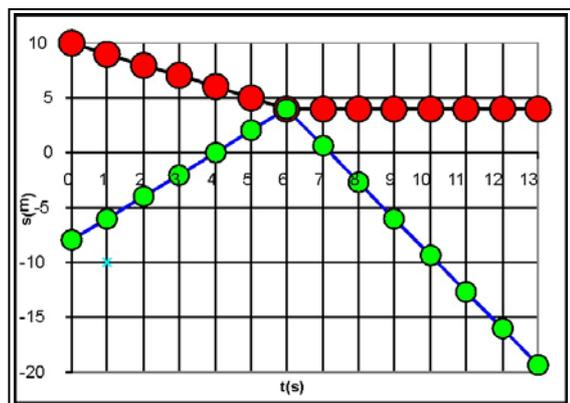
3.5.33. La gráfica posición/ tiempo de la figura corresponde a la representación del movimiento rectilíneo de dos cuerpos A(rojo) y B(verde), cuyas masas suman 6 kg, en un sistema de referencia de laboratorio, observándose que colisionan frontalmente a los 6s. Del análisis de dicha gráfica sacarás la conclusión que las velocidades respectivas después de la colisión en un sistema de referencia del centro de masas serán:
