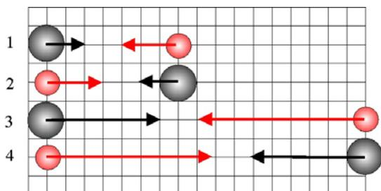
3.5.28. El esquema que te dan corresponde al movimiento unidimensional de dos esferas A (negra) y B (roja), de masas respectivas 3 y 2 kg, sobre una mesa sin rozamiento y cuyos vectores velocidad son los dibujados (cada cuadrado una unidad SI), suponiendo que la colisión que efectúan sea elástica, los vectores velocidad de A y B, respectivamente antes de la colisión en un sistema de referencia del centro de masas serán de los esquematizados:
