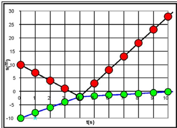
3.5.34. La gráfica de la figura corresponde a la representación posición/tiempo del movimiento de dos cuerpos A y B, que se desplazan por el eje de las X y cuyas masas suman 10 kg, en un sistema de referencia de laboratorio, observándose que colisionan frontalmente a los 4s. Del análisis de dicha gráfica sacarás la conclusión que las velocidades respectivas después de la colisión en un sistema de referencia del centro de masas serán en m/s:
