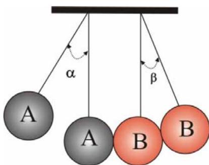
3.5.46. Si dispones de 2 esferas A y B, de igual masa, en sendos péndulos de igual longitud L, y paralelos. Separas A un cierto ángulo  $\alpha$  y la sueltas, con lo que colisiona con B, con un coeficiente de restitución e, de tal forma que B se separa formando otro ángulo  $\beta$ . Podrás decir que en dicha colisión la relación entre los senos de los ángulos mitades de  $\alpha$  y  $\beta$   $[(\sin \alpha / 2) / (\sin \beta / 2)]$  es :
