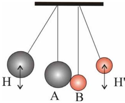
3.5.47. Si dispones de 2 esferas, A de masa  $2m$  y B de masa  $m$ , en sendos péndulos de igual longitud  $L$ , y paralelos. Separas A hasta que alcance una altura  $H$ , y la sueltas, golpeando con B, con un coeficiente de restitución  $e$ . La altura  $H'$ , alcanzada por B en dicha colisión será:
