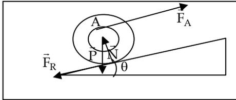
4.2.30\*. Si una polea compuesta de masa \$M\$, formada por dos cilindros coaxiales de radios \$R\$ y \$R/2\$ respectivamente, asciende rodando sin deslizar, por un plano inclinado, mediante la fuerza que se puede aplicar a través de una cuerda según se enrolle ésta, en los puntos \$A\$ y \$B\$. En estas situaciones y si las aceleraciones de los centros de masas son los mismos, puedes comprobar que:
