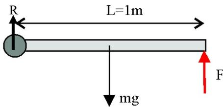
4.2.34\*. Una varilla delgada homogénea de 1 metro de longitud y masa 1 kg se encuentra sujeta por un extremo y en posición horizontal, gracias a la fuerza F que haces para sostenerla en el otro extremo. Si la sueltas dirás que:
