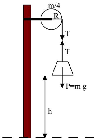
4.2.32\*. En el esquema de la figura cuelga un peso de masa  $m$ , de una polea de masa  $m/4$  y de radio  $R$ , que lleva enrollada una cuerda. El m.d.i de la polea es  $mR^2/2$ . Se cumple que:
