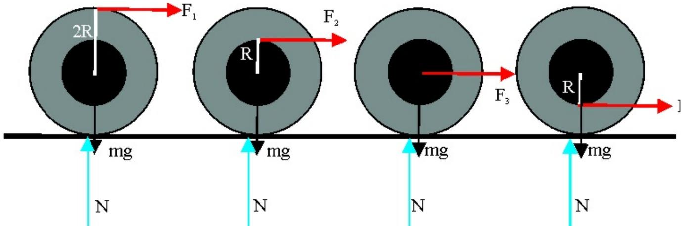
$F_1$  producirá un momento,  $2R F_1$ , que lo hará girar en sentido horario, y con una aceleración angular el doble que  $F_2$ . En cambio  $F_4$ , producirá un momento que provocará un giro antihorario, mientras que  $F_3$  sólo provocará un movimiento de traslación al estar aplicado en el centro de masas del sistema. Solo es correcta la b.
