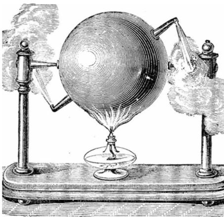
4.2.23\*. La primera máquina térmica, esto es dispositivo que por acción del calor, producía movimiento fue la eolipila de Herón de Alejandría (siglo I dC.), también mal llamada fuente de Eolo. En el esquema que te dan, el vapor de agua producido al salir por los tubos curvados, producía el giro de la esfera. El estudio dinámico de este hecho, te permitirá decir que:
