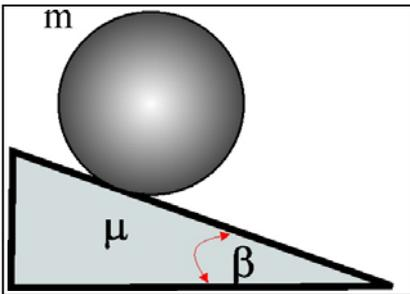
4.2.27. Si el coeficiente de rozamiento entre una esfera homogénea de 10 kg y 0,1m de radio, situada en lo alto de un plano inclinado  $30^\circ$  es de 0,1 la relación entre la aceleración angular y la aceleración del centro de masas de la esfera es en rad/m, igual
