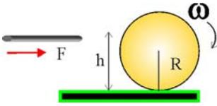
4.2.19. Para que una bola de billar de radio  $R$ , ruede sin deslizar por la mesa, con la que el rozamiento es despreciable, deberá golpearse a una altura:
