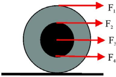
4.2.22. Sobre una misma polea formada por dos cilindros coaxiales de radio  $R$  y  $2R$ , respectivamente, que puede desplazarse sobre un suelo horizontal sin rozamiento, pueden actuar las cuatro fuerzas, con el mismo módulo, del esquema dado. Del efecto producido por las mismas dirás que:
