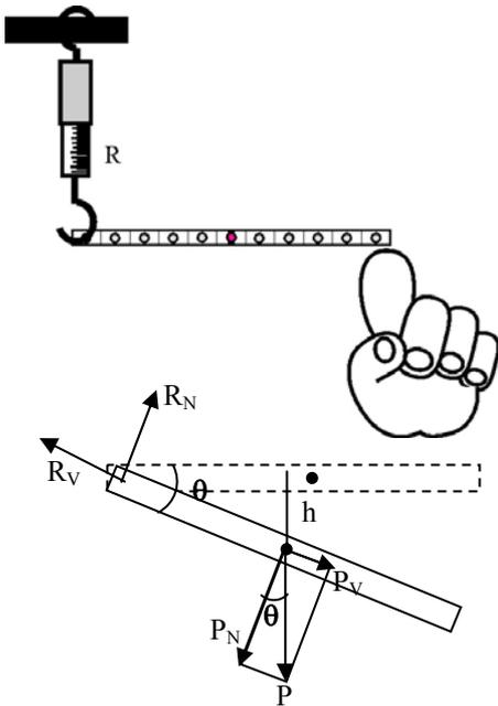
4.2.33. Soportas una palanca didáctica desde el orificio de su extremo, con un dinamómetro sensible, sujetándola horizontalmente con un dedo por el otro. La sueltas. La relación entre las reacciones que soporta el pivote (dinamómetro) cuando forma un ángulo de  $30^\circ$  con la horizontal, y cuando es de  $60^\circ$ , es una constante que vale:
