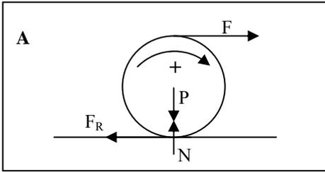
4.2.31. Si en un carrete de masa  $m$ , enrollas un hilo, y tiras de él con una fuerza  $F$ , como aparece en las figuras A y B; de forma que se desplace girando y deslizando, sobre la horizontal, deberá cumplirse que:
