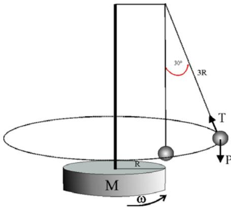
4.3.16. En el esquema de la figura, al girar una plataforma de masa  $M$ , y radio  $R$ , con un soporte de masa despreciable del que cuelga un péndulo simple, de longitud  $3R$ , éste se separa un ángulo de  $30^\circ$ , con este dato podrás asegurar que la energía cinética de rotación de la plataforma será:
