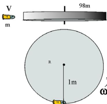
4.4.20. Se dispara una bala de masa  $m$  con una velocidad  $v$ , sobre un disco de masa  $98m$ , y radio  $R=1m$ , en reposo capaz de girar por un eje que pasa por su centro. La bala queda incrustada en la periferia del disco. La velocidad con que girará el sistema bala disco después del impacto será en  $rad.s^{-1}$ :
