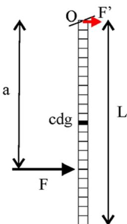
4.4.16. Dada la palanca didáctica del dibujo, de masa  $m$  y longitud  $L$ , capaz de oscilar desde su extremo  $O$ , al aplicar una fuerza  $F$ , a una distancia de  $O$ ,  $\frac{3}{4}$  de  $L$ , dirás que la fuerza de reacción que ejerce el eje de giro sobre la varilla en ese instante es:
