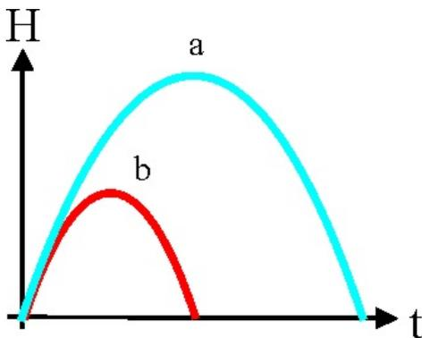
35. En la figura se muestra la gráfica posición/tiempo del lanzamiento vertical de un cuerpo en diferentes planetas a y b, de la misma masa, de forma que la velocidad inicial en el b es el doble de la de a. De ellos podrás asegurar que:
