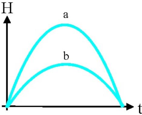
31. En la figura se muestra la gráfica posición/tiempo del lanzamiento vertical con la misma velocidad inicial de un cuerpo en diferentes planetas a y b, de aparentemente el mismo tamaño. De ellos podrás asegurar que:
