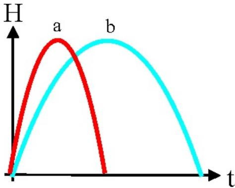
34\*. En la figura se muestra la gráfica posición/tiempo del lanzamiento vertical de un cuerpo en diferentes planetas a y b, de aparentemente el mismo tamaño, de forma que la velocidad inicial en el a es el doble de la de b. De ellos podrás asegurar que:
