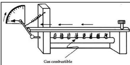
233. En la figura se presenta un dilatómetro clásico, para sólidos que trata de medir la dilatación lineal de una barra metálica sujeta con un tornillo, para ello necesita de:
