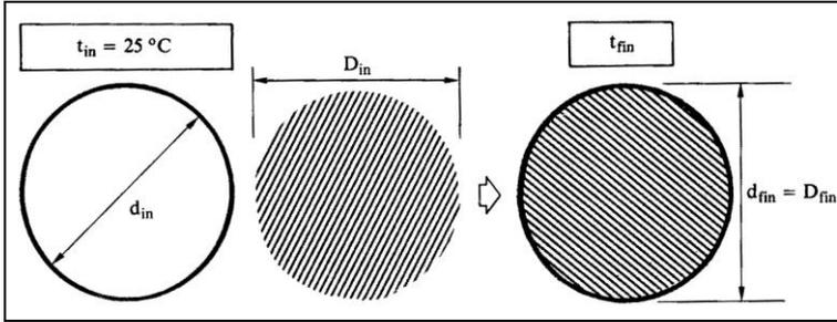
230. Un aro de acero que envuelve una rueda, tiene un diámetro interno de 58,45cm, debe ser montado sobre la rueda de hierro fundido cuyo diámetro es de 58,55cm, medidos a 25°C. Las dos piezas se calientan juntas para a una determinada temperatura encajen perfectamente. Esta temperatura será aproximadamente:
