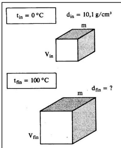
232. Se dispone de un cubo metálico de densidad  $10,1 \text{ g/cm}^3$  a  $0^\circ\text{C}$ , de un material cuya coeficiente de dilatación lineal es  $1 \cdot 10^{-6} \text{ }^\circ\text{C}^{-1}$ , se calienta hasta los  $100^\circ\text{C}$ , este hecho hace que su densidad aproximadamente:
