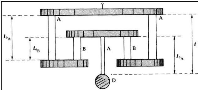
235. Un péndulo compensado es un dispositivo pendular de la figura que se da, en el que las posibles dilataciones se compensan para evitar los errores. Siendo  $\alpha_A$  y  $\alpha_B$ , los coeficientes de dilatación respectivos a las barras A y B, será necesario para ello que:
