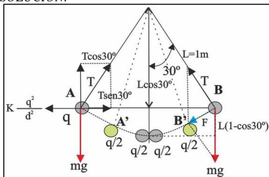
Suponiendo inicialmente cargas las esferas puntuales A y B, con una carga q se mantendrán en equilibrio, tal como se han presentado en los test anteriores. Si se descarga B, tal como se ve en la figura, la otra esfera mantiene su carga, pero ya no están en equilibrio al desaparecer las fuerzas de interacción eléctrica, con lo cual las esferas descenderá una altura  $L(1-\cos 30^\circ)$ . Con una velocidad, tal que la energía potencial se convertirá en cinética
