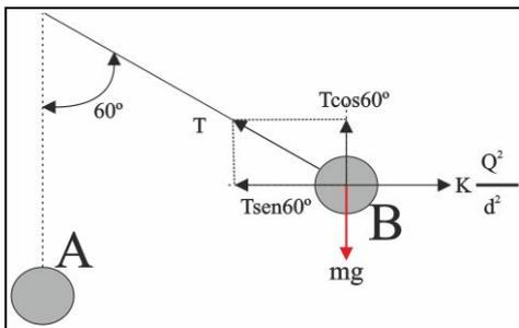
94. Una esfera A, electrizada con una carga de  $0,1\mu\text{C}$ , se aproxima a un péndulo electrostático, formado por otra esfera B, de  $0,4\text{g}$  de masa, electrizada con otra carga igual. Si el sistema se encuentra en el aire, y la posición final de equilibrio es la dada en el dibujo, dirás que la esfera B, se separará una distancia en m. de:
