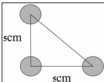
92. Tres cargas eléctricas positivas e iguales de  $5 \mu\text{C}$ , se encuentran en los vértices de un triángulo rectángulo cuyos catetos valen  $5 \text{ cm}$ . En este caso dirás que la fuerza que se ejerce sobre la carga situada en el vértice del ángulo recto vale:
