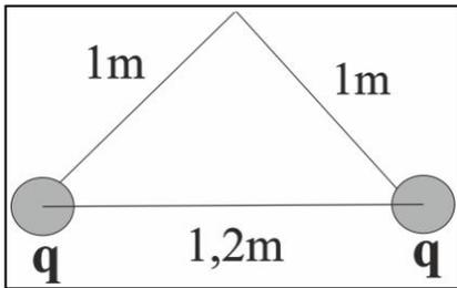
99. Dos esferas conductoras muy pequeñas e iguales de 30g de masa, se encuentran suspendidas de hilos de 1m, sujetos a un mismo punto, como se observa. Estando separadas, se electriza solo a una de ellas. Se ponen en contacto, y se abandonan. Si el equilibrio se restablece cuando la distancia de separación entre ellas es de 1,20m, la carga suministrada será en  $\mu C$  de:
