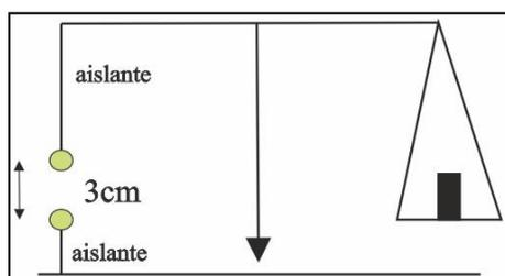
97. Uno de los platos de una balanza en equilibrio es una esfera electrizada A. Al aproximarse otra esfera B, con la misma carga, el sistema se equilibra colocando  $2,5g$  en el plato de la balanza. En esta situación dirás que la carga de B será en  $\mu C$ :
