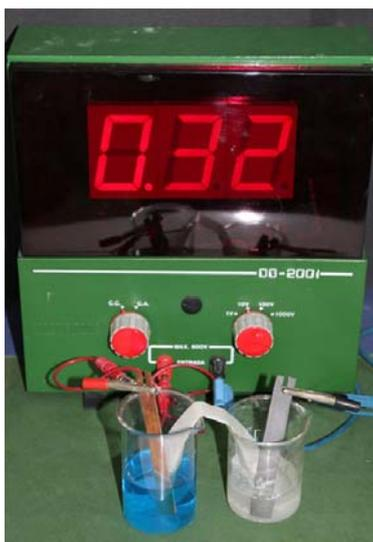
137\*. En el montaje dado, se observa una pila entre una lámina de cobre sumergida en una disolución de sulfato de cobre(II), y otra de estaño inmersa en otra de cloruro de estaño. Teniendo en cuenta los potenciales normales de la tabla, podrás asegurar que:
