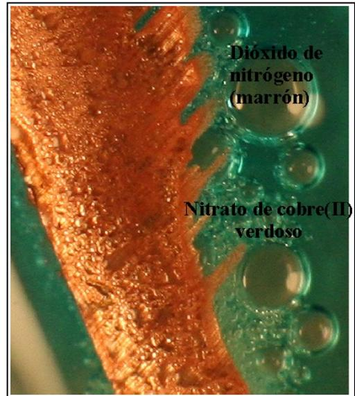
121\*. En las fotos se muestra la reacción entre el ácido nítrico concentrado y el cobre, indicándose los productos de la reacción. La observación de las mismas y el ajuste correspondiente, te hará decir que:
