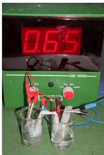
140\*. En el montaje dado, se observa una pila entre una lámina de Zn sumergida en una disolución de sulfato de cinc, y otra de estaño inmersa en otra de cloruro de estaño. Teniendo en cuenta los potenciales normales de la tabla, podrás asegurar que:
