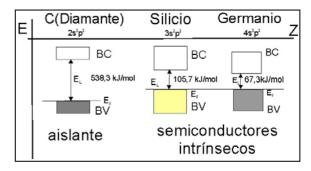
En los semiconductores (Si y Ge), la laguna de energía  $E_L$  (espacio entre bandas) es suficientemente pequeña, y con un aporte de energía térmica se supera fácilmente saltando los electrones de la BV( banda de valencia), nivel de Fermi( $E_F$ ) a la BC (banda de conducción), como se aprecia en la figura. La respuesta correcta es la d.
